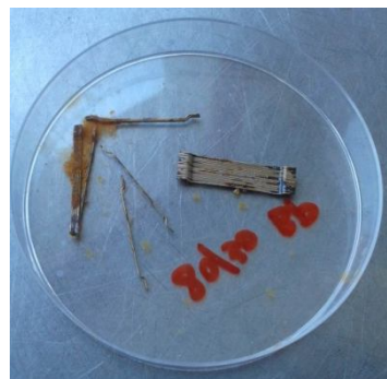
Fibre corrodibili, prova non superata
